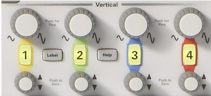
圖 5 示波器垂直 (Y 軸) 控制項
