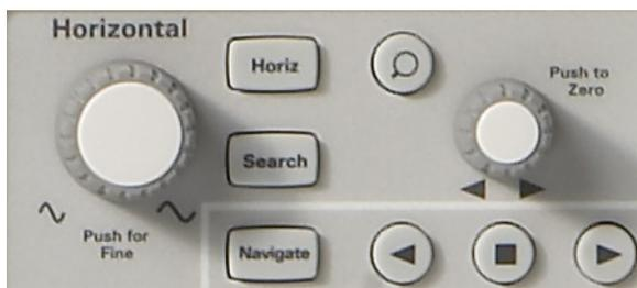
圖 4 示波器水平 (X 軸) 控制項
